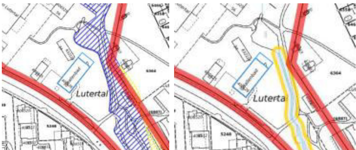
Abbildung 21: Analyse Hallenverlängerung um rund 6.6m anhand Gefahren- und Gewässerraumkarte
